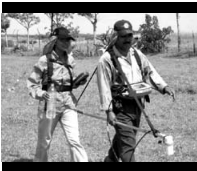
Foto 1. Recorrido con el magnetómetro y GPS
