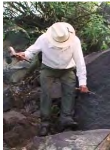
El cantero comienza a golpear la piedra “china” para extraer fragmentos más pequeños. Fotografía de José Zamora
